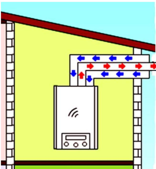
Газовое оборудование с герметичной камерой сгорания и индивидуальным коаксиальным отводом продуктов сгорания
